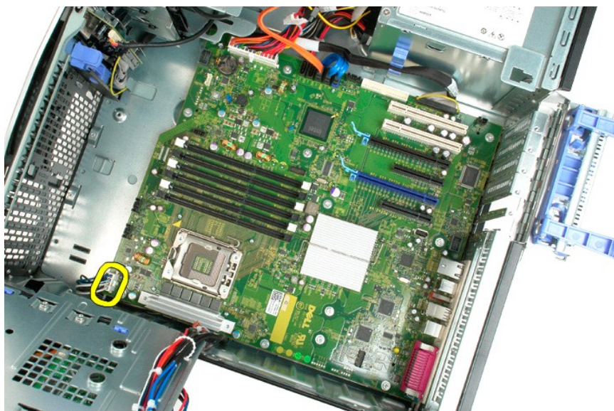
11. Odklopite kabel za napajanje sistemske plošče.
